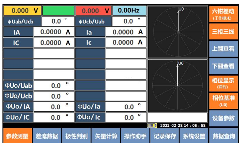
六钳三相三线测量界面（相位滞后/U0 基准）
