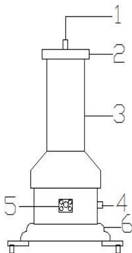
1. 高压引出接线柱（可连接微安表和水电阻或限流电阻）
