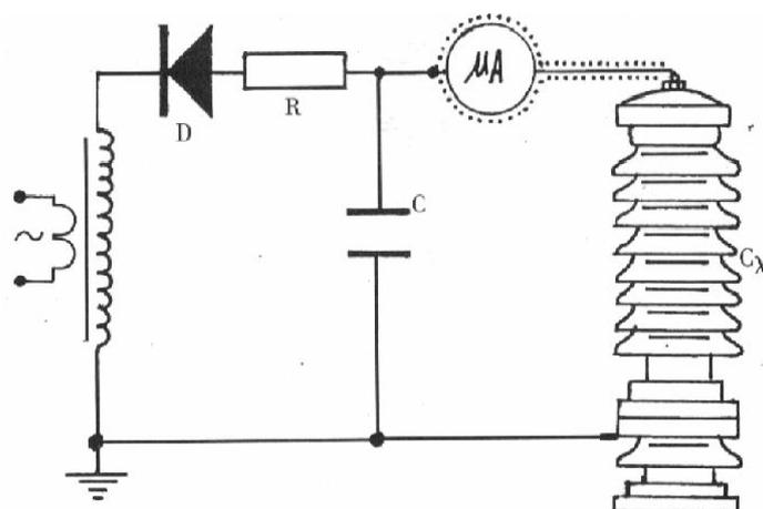
微安表接入试品 CX 高压侧接线图
