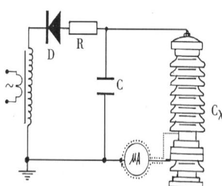
图 8b 排除试品  $C_X$  表面影响接线图
