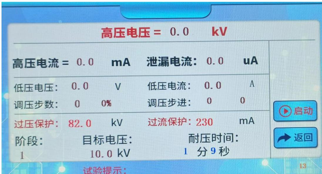
上图中，“阶段 1”：表示当前将进行的试验阶段，“目标电压”表示自动试验中当前阶段的目标电压，“耐压时间”表示自动试验中当前阶段的耐压时间。
