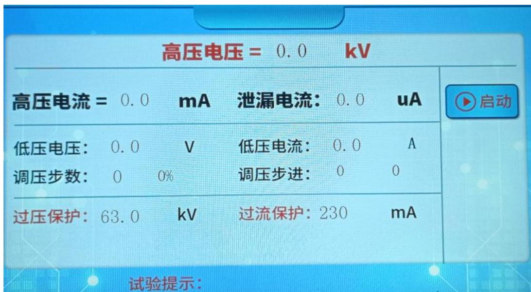
**说明：**设置的保护参数都需要通过触摸屏完成。点击后弹出数字键盘就可以进行设置了。
