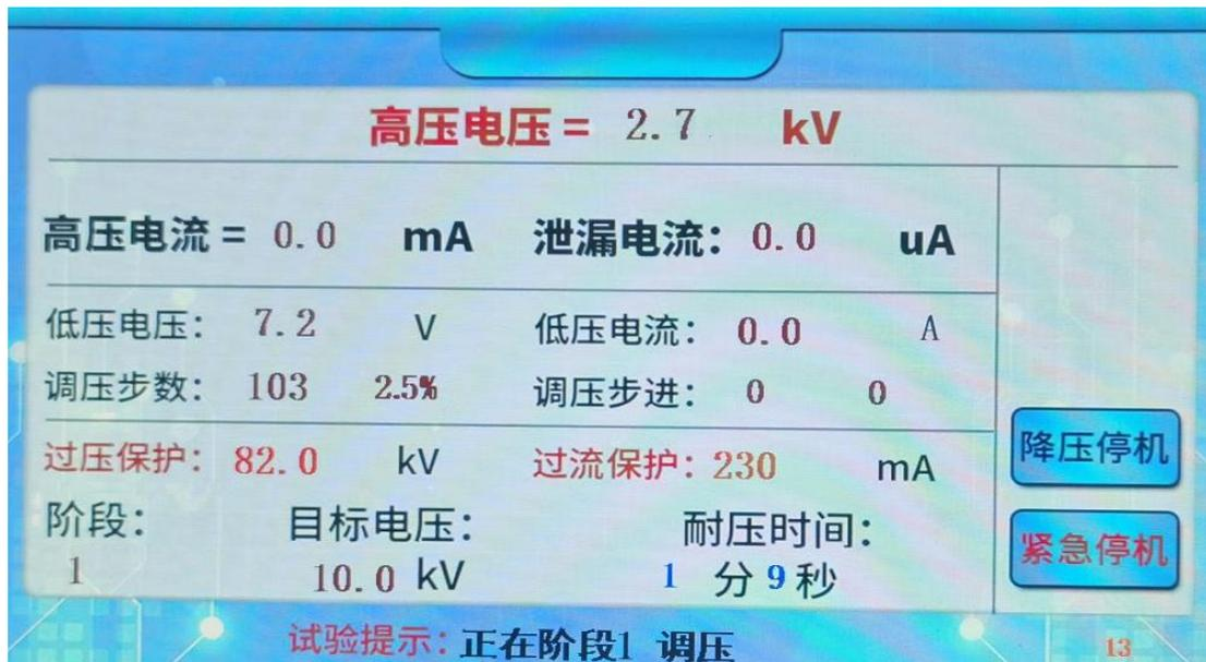
在试验中途可以按“降压停机”降压停机，遇到紧急情况按“紧急停机”直接停机。
