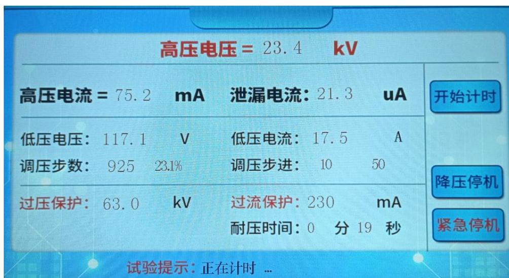
1. 主要试验数据区，显示试验数据/结果，包括：高压电压，高压电流和泄漏电流。
