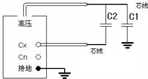
打开反接线低压屏蔽，可在上端电容 C1 不拆母线的情况下，对其进行不拆线 10kV 反接线介损测量。如下图所示：母线挂地线，C1 上端不拆线，C1 下端接高压线芯线，C2 末端接 Cx 芯线。仪器采用反接线/10kV/M 测量方式，可同时测出 C11 和下端屏蔽部分的电容量和介损值。
