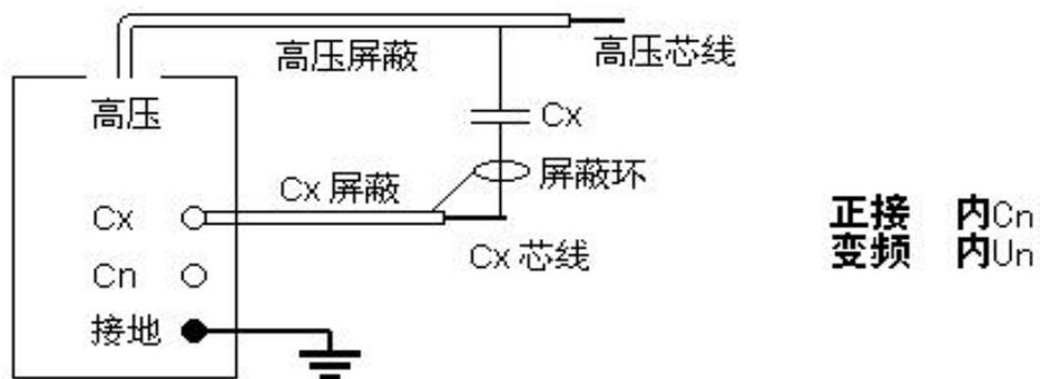
2.2 反接线、内标准电容、内高压（常规反接线）：
