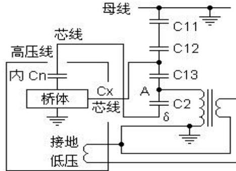
CVT 自激法测量中，仪器先测量  $C_1$ ，然后自动倒线测量  $C_2$ ，并自动校准分压影响。
