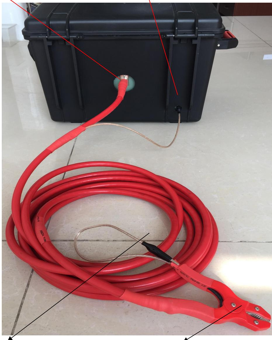
小黑夹子为高压屏蔽一般悬空(带有高压) 大红夹子接被测试高压部分
