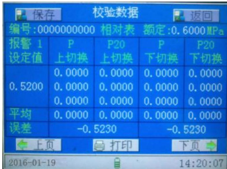
按上页 下页键可以查看报警 1，报警 2，闭锁 1，闭锁 2，超压的检测数据。按保存键将把测量结果保存在仪器中，按测量时间进行排列，可以在菜单界面的历史数据中进行查询。
