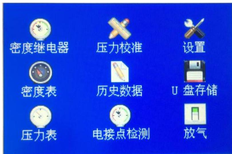
2) 点击密度继电器进入触点电阻测量界面，测量完毕点击确定键进入密度继电器校验模式。
