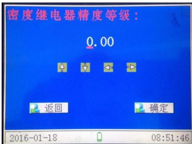
2) 仪器会提示压力类型、环境温度、采集次数、继电器编号、密度继电器等，按要求输入进入下一菜单，只有设置了相关参数，仪器才能开始测量。
