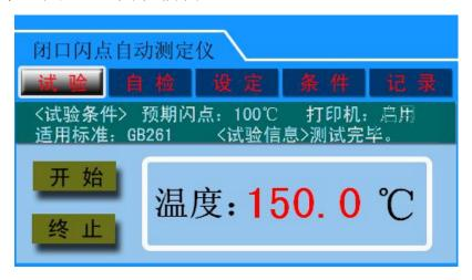
点击"开始",测试臂落下,开始测试;点击"终止",停止试验,测试臂升起。"试验条件"处显示测试的设定条件,包括预期闪点、打印机开关设置、试验所适用的标准等。"试验信息"处显示试验的进程信息。
