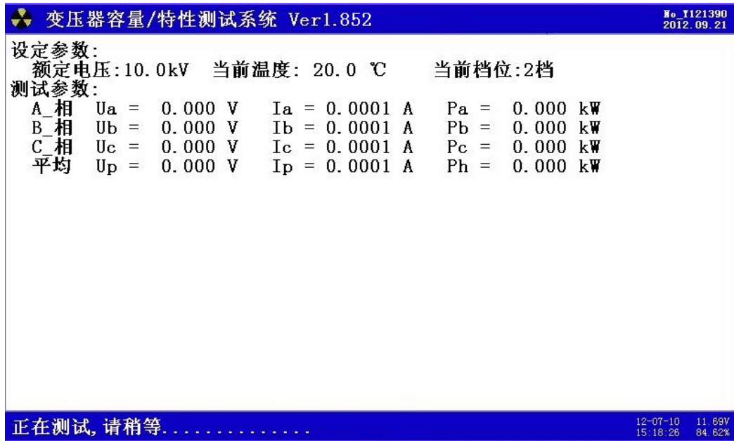
图 5、容量测试（进行中）
