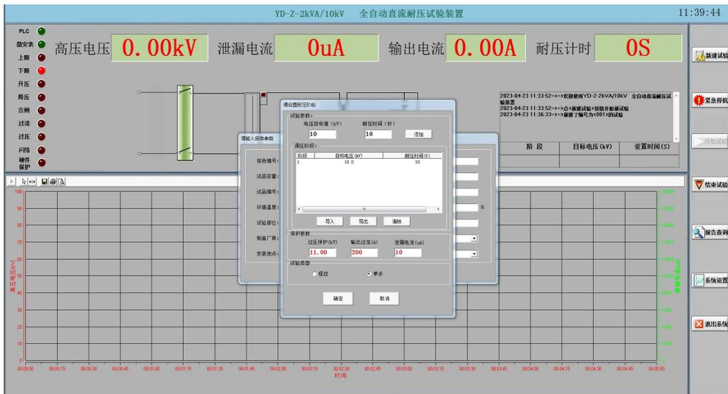
点击合闸，升压，升至目标电压，同时观察电压电流的变化
