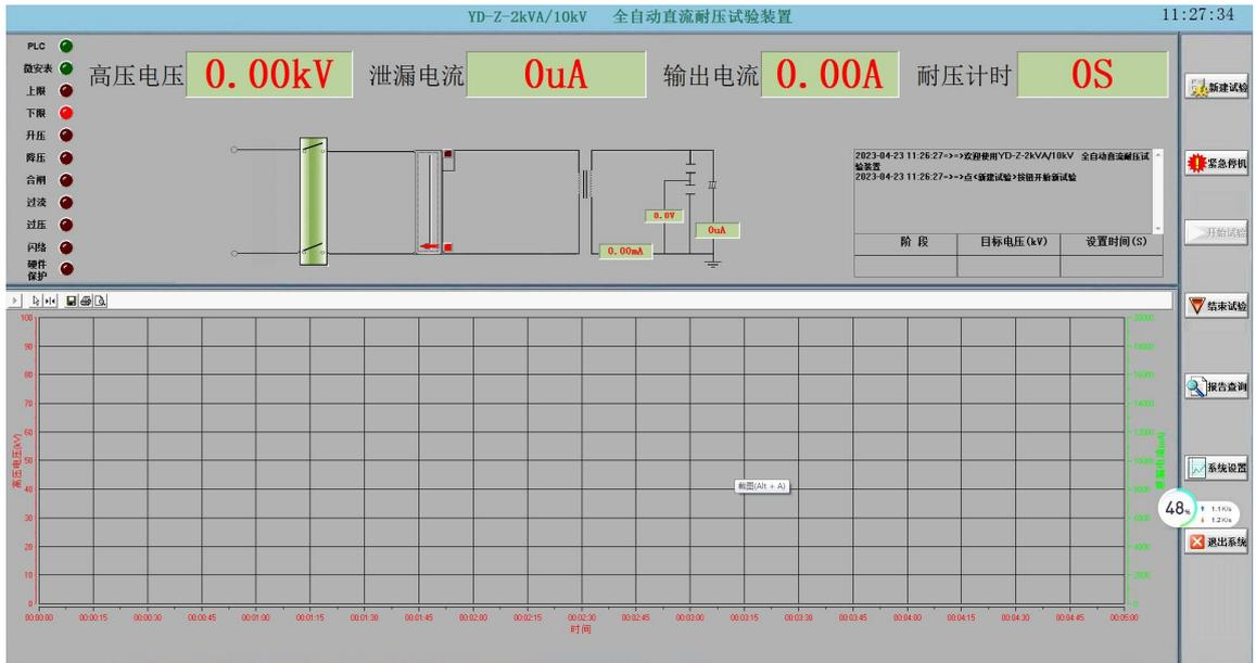
2, 如上图, 点击右侧“新建试验”根据被试品参数完整填写上图表格
