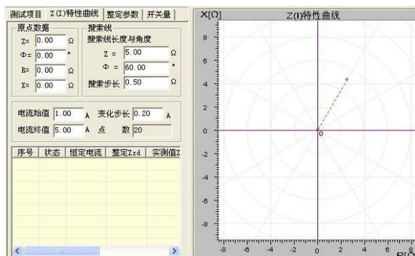
本试验的方法过程很像做差动继电器试验。如果把这里的阻抗比做差动试验的“制动电流”，则这里的电流就相当于“动作电流”。试验时，阻抗初始值为 0，按一定的搜索步长增加。测试在每一个阻抗值下，保护的動作电流。测试完毕，软件会自动绘制出相应的曲线。“Z(V)特性曲线”参照“Z(I)特性曲线”。
