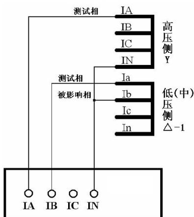
Y 侧相位调整, 无零序修正, 按单相短路接线
