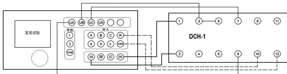
标点击  $U_c$  数值框，直接输入  $-110$ ，按回车键），即在第 7 端施加启动电压以启动重合闸，重合闸启动后，等待重合闸时间到，接点动作，即可测出动作时间。
