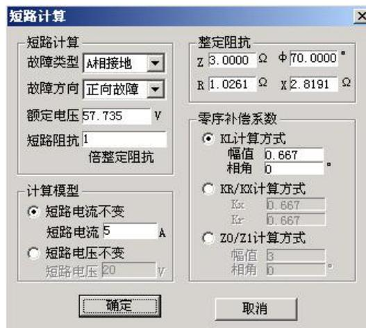
的“短路阻抗”和该“短路电压”计算出相应故障类型下的“短路电流”。做“距离保护”试验时，有时可通过灵活设置短路电流，在不退出零序保护的情况下躲开零序保护的抢动。
