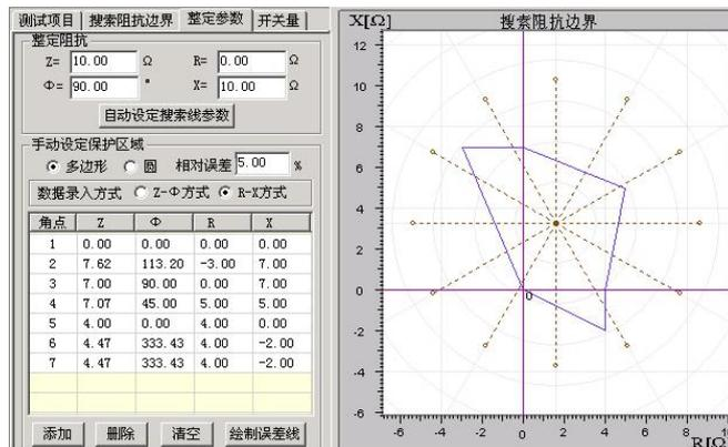
都可以设置为负数。各角点添加完后点击“画图”按钮，至此软件即绘出了理论的阻抗边界曲线以及相应的误差曲线（以虚线表示）。此时可用鼠标移至图形的中心位置点击鼠标左键，以设置扫描中心点，如右图所示。
