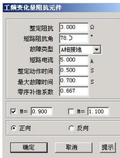
工频变化量阻抗元件对话框，包含以下配置项：
