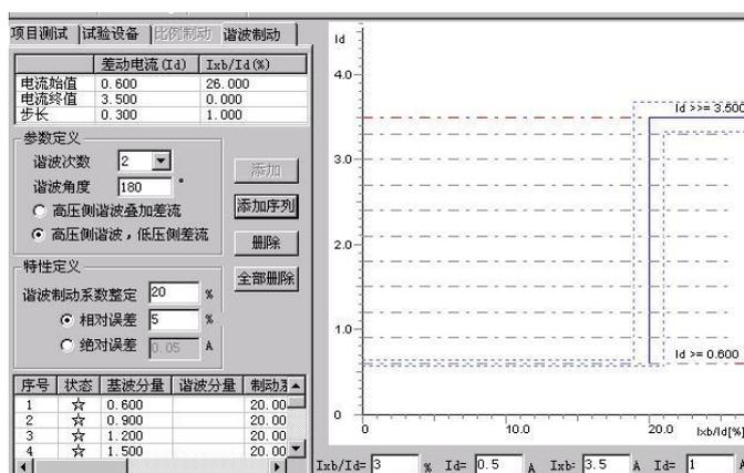
“添加”将搜索线数据填入测试数据列表中。选“开始试验”即可进行测试。选“删除”或“全部输出”可以删除搜索线。
