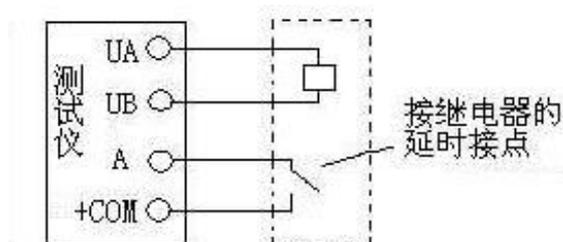
选择“手动”试验方式。开始输出一定时间后，就能测试出其动作时间。
