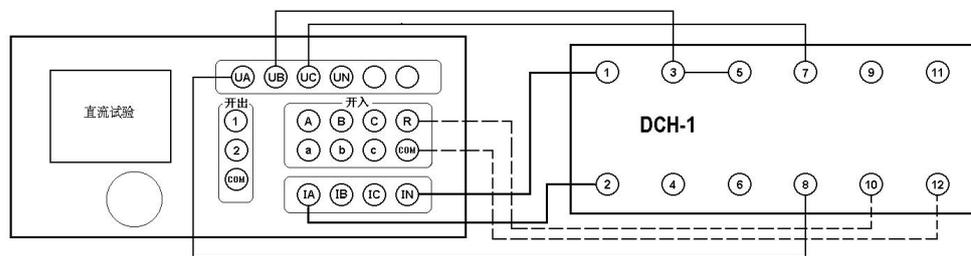
注意：若重合闸能充电但不能动作，请检查保持电流是否有输出。在充电期间，电流输出回路是断开的，所以测试仪的电流输出开路指示灯亮。当重合闸动作时，测试仪的电流输出开路指示灯应熄灭。
