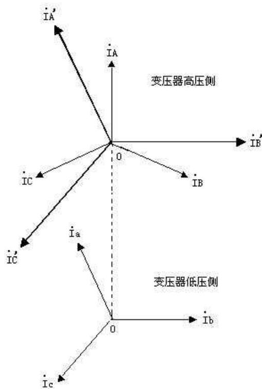
等，方向相反。试验时，为了平衡高压侧C相上的电流，就在低压侧的c相上加一补偿电流，并且，所加的补偿电流应与加在低压侧a相上的电流大小相等，方向相反。
