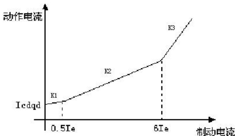
说明：上述曲线实际上有三个拐点， $I_{g1}=0$ ， $I_{g2}=0.5I_e$ ， $I_{g3}=6I_e$
