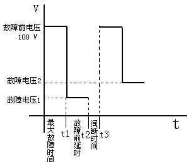
这样，测试仪的输出总是从正常电压 100V 突变到故障电压。整个输出变化过程如右图所示：
