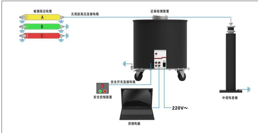
单端测试接线图（加补偿电容）
